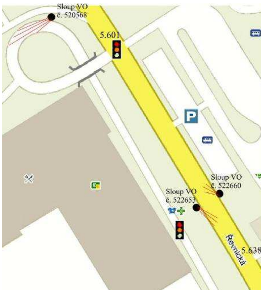
Obr. 12 Schematické znázornění sběru dat strategickým detektorem u Metropole Zličín
