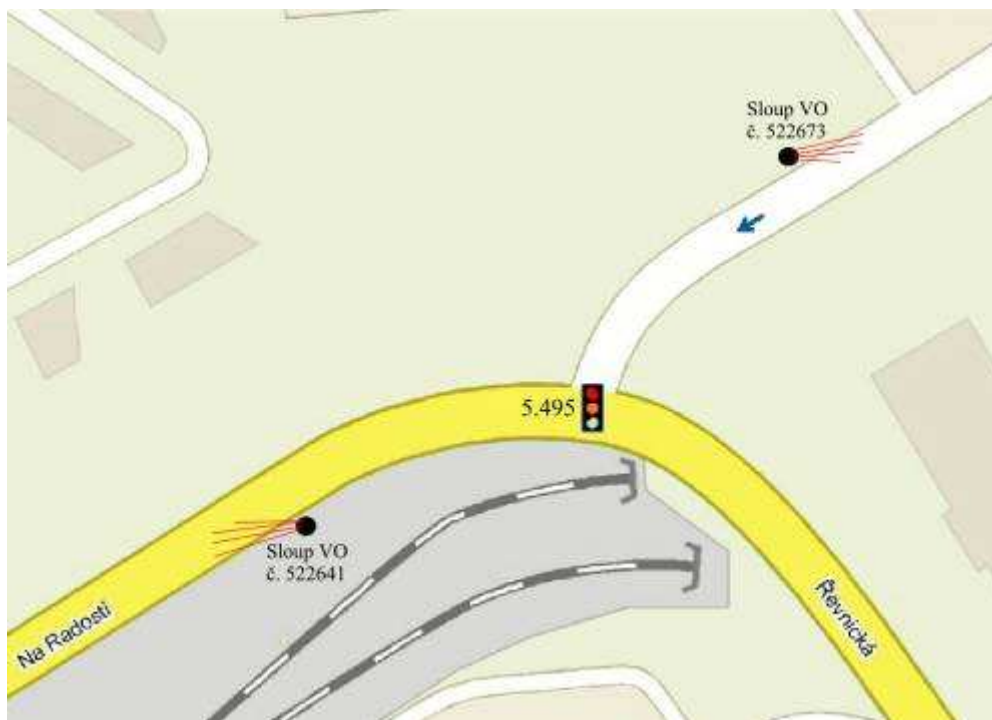
Obr. 13 Schematické znázornění sběru dat strategickým detektorem v ulici Na Radosti
